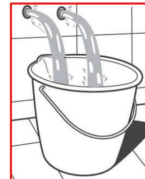
**Per installatore: Al fine di garantire la durata del prodotto installare rubinetti con filtro da pulire periodicamente. Effettuare risciacquo delle tubazioni prima di installare il prodotto (PUNTO 1). Eventuali residui se finissero all'interno della cartuccia potrebbero causarne il danneggiamento**
